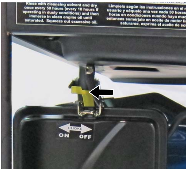
Figura 18 – Palanca del cebador
