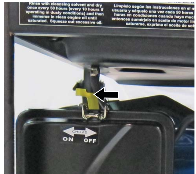
Figura 23 – Palanca del cebador
